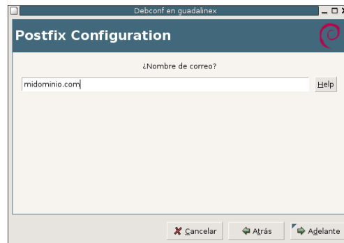
Figura 2.3: Instalación Postfix - Dominio de correo
